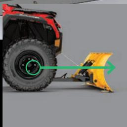
Монтажная пластина крепится к днищу, обеспечивая оптимальный угол атаки и максимальное толкающее усилие.
