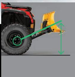
Переднее размещение рамы обеспечивает максимальную высоту подъема.
