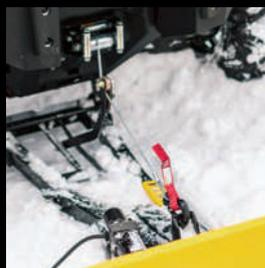
Понимайте отвал до защелкивания на монтажной пластине.
